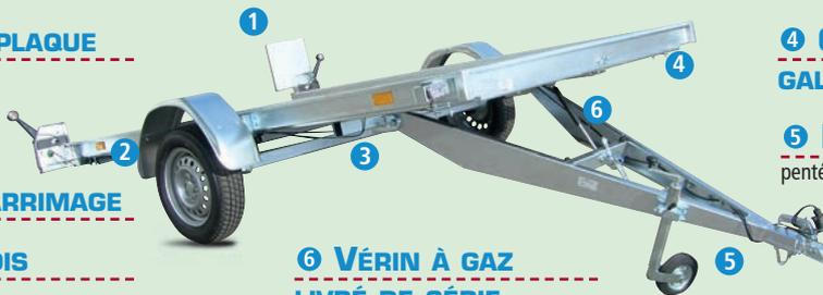
**4 CHÂSSIS SOUDÉ GALVANISÉ À CHAUD**
