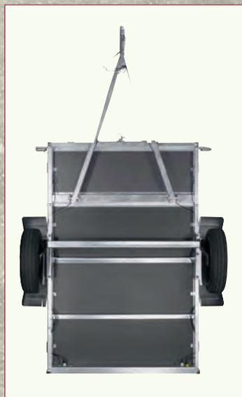
**CHÂSSIS MÉCANO-SOUDÉ ET GALVANISÉ À CHAUD**
