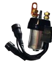
⋮ ITR001938 Relais de démarrage centrale SPX EF-1070 - 12/24V.
