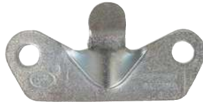
..... ITR000341 ..... Crochet seul pour poignée de basculement. ..... 85 x 39 mm. Entraxe : 65 mm. Ø 9 mm. ..... Capacité : 800 kg.
