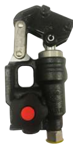
1FK6487 Pompe manuelle simple effet en ligne sans réservoir. Volume par course : 20 cm 3 . - Pression max. : 150 bar. Tige : Ø20 mm.
