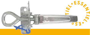
..... IFK60009 - FFK60009B B ..... Poignée de basculement + crochet. ..... L. 264 x l. 85 x H. 47 mm. Entraxe : 65 mm. ..... Capacité 1 190 kg. Crochet : ITR000341 .
