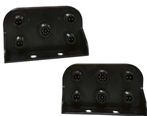
ITR003924 Boîtier de connexion. 11 connecteurs. 8 x 2 broches et 3 x 8 broches. 81 x 55 x 47 mm.
