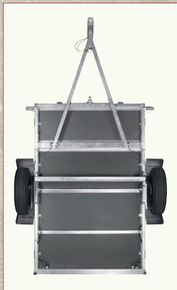
**CHÂSSIS MÉCANO-SOUDÉ ET GALVANISÉ À CHAUD**
