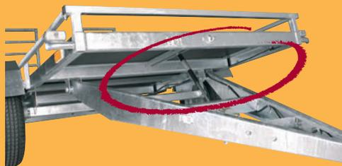
Vérin pour ralentir la descente du plateau basculant. Flèche en V soudée et pentée.
