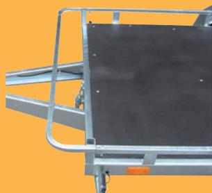
Plancher antidérapant. Rancher robuste permettant l'arrimage.
