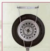
Porte roue de secours sous châssis
