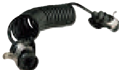
→ 6911 Prolongateur 24 V, ABS, avec prise 5 plots 3,50 m. Alimentation 2 x 2,5 mm 2 + 3 x 1,5 mm 2 . ISO 7638.
