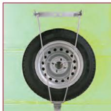
Porte roue de secours sous châssis
