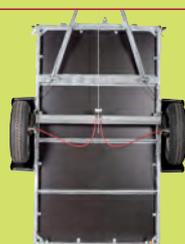
Châssis entièrement mécano-soudé avec traverses de renfort.
