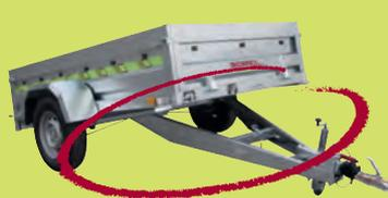
Basculante. Flèche en V et pentée, profil en C, galvanisée.
