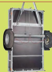
Rampe de feux intégrée permettant le stockage vertical.
