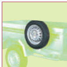
Porte roue de secours latéral (pouvant recevoir un cadenas)
